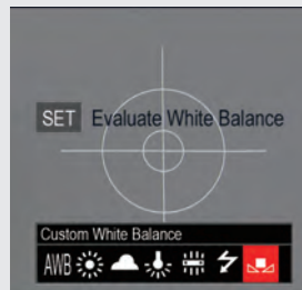
3 イージーバランスにフォーカスし、マニュアルホワイトバランスを設定。露出を0になるよう、絞りとシャッタースピードをマニュアル調整
