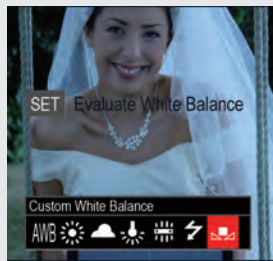
3 イージーバランスにフォーカスし、マニュアルホワイトバランスを設定。露出を0になるよう、絞りとシャッタースピードをマニュアル調整
